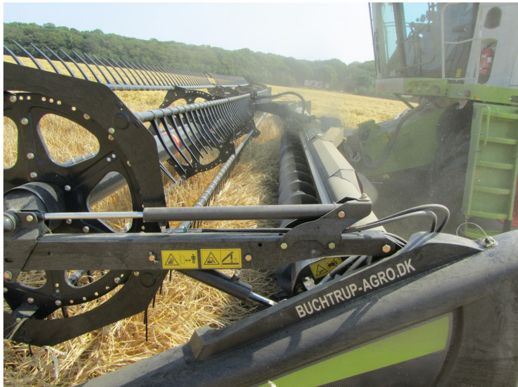
Billede 6. Båndet giver mere ensartet indføring i tærskværket, hvilket medfører mere ens tærskning.
