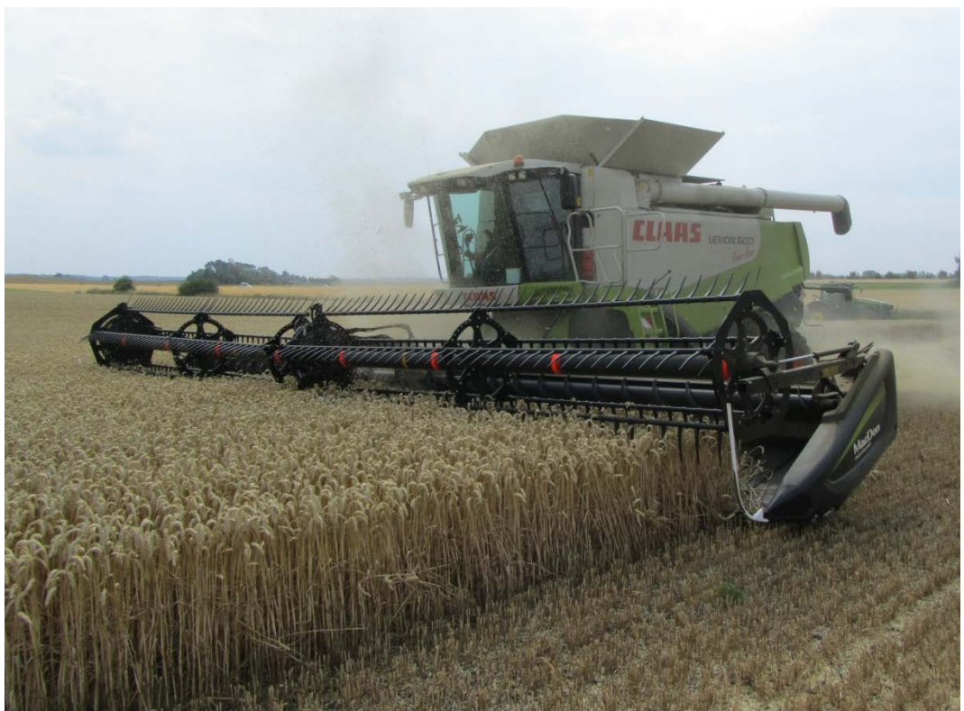
Billede 4. Mejetærskeren monteret med 40 fod MacDon skærebord.
