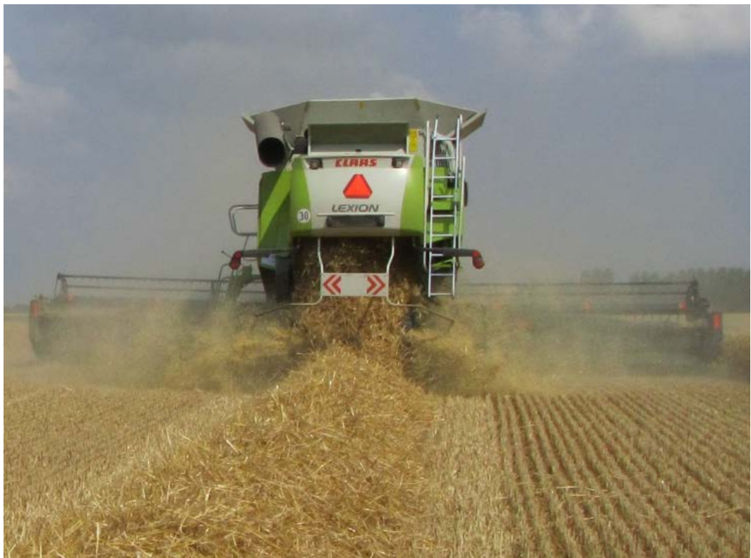
Billede 8. Ved montage af et bredere skærebord kan det ikke altid påregnes, at snitter og avnespreder kan håndtere den større arbejdsbredde tilfredsstillende.
