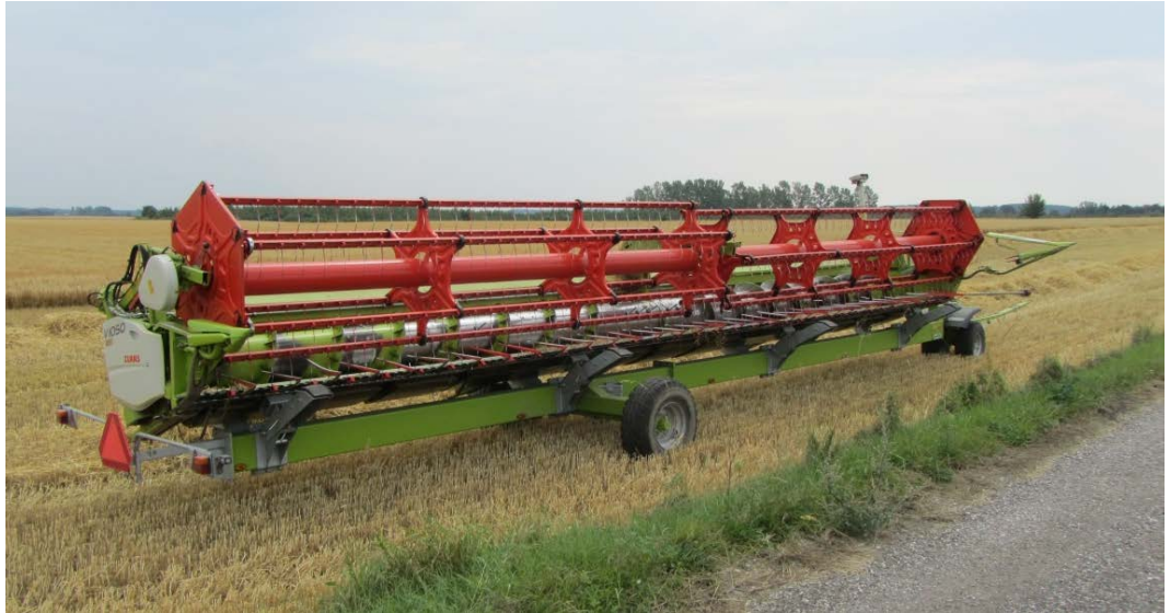
Billede 3. Det fabriksmonterede 35 fods skærebord med variabel skærebordslængde (vario-bord).
